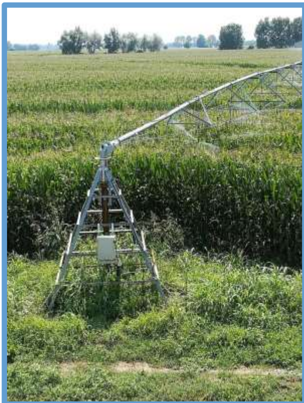
Figura 1 – L'impianto per l'irrigazione con pivot utilizzato per la fertirrigazione
